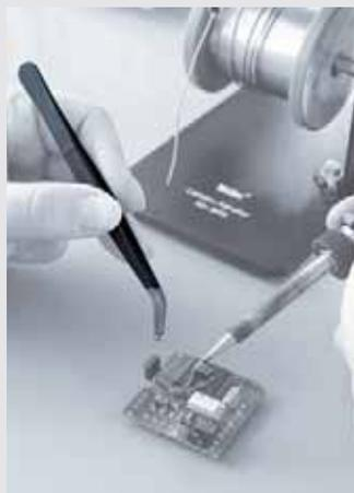
*Les pincettes sont des outils importants pour chaque électronicien, afin de pouvoir exécuter de manière sûre les travaux nécessaires dans les structures souvent petites et étroites des circuits imprimés.*
