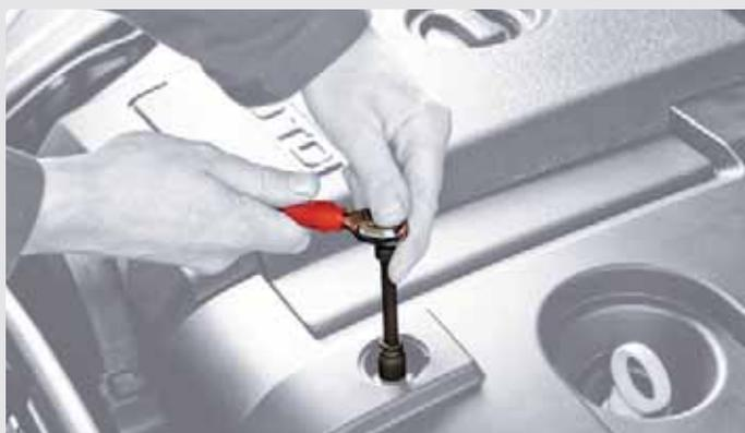
acier spécial au chrome-vanadium et trempés à cœur, ce qui les rend particulièrement résistants aux chocs et à la casse. Le programme universel est complété par des adaptateurs universels et des cliquets à grande facilité de mouvement. Avec un joint de cardan (adaptateurs) et une tête de verrouillage (cliquets) pour le maintien et le desserrage rapide des outils enfilés, vous êtes parfaitement équipé pour les travaux aux endroits difficilement
