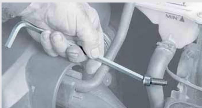
En outre, les clés mâles Magic Ring® de Wiha maintiennent aussi parfaitement des vis non magnétisables en inox, titane et aluminium.
