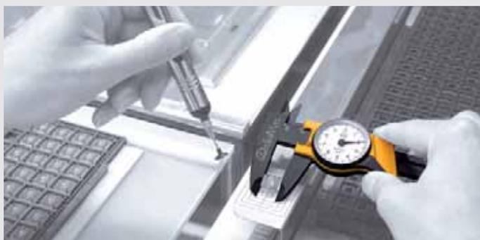
copeaux métalliques attirés et ainsi la dégradation de la précision de mesure. L'utilisation dans des environnements de travail humides ne pose aucun problème aux pieds à coulisse Wiha grâce au matériau insensible à la corrosion.
