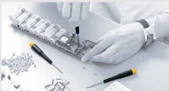
Les tournevis ESD de Wiha sont conformes à la norme internationale en matière d'ESD, IEC 61340-5-1. La résistance électrique de surface est de  $10^6 - 10^9$  ohm. Le capuchon pivotant du manche et les larges faces d'appui pour les doigts permettent de visser rapidement et sans fatigue. Pour des couples de serrage plus élevés, il existe des tournevis avec un manche plus volumineux.
