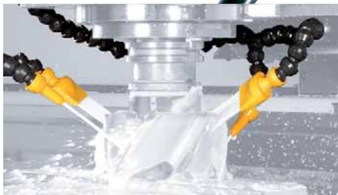
*Indéformable, adaptable à chaque application et d'une grande longévité – le système universel de flexibles d'arrosage maxiflex<sup>®</sup> de Wiha.*
