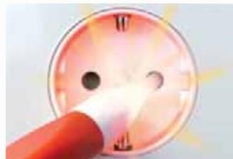
La broche de contrôle détecte la phase et le conducteur neutre
