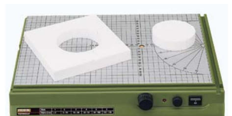
Une solution simple et efficace pour découpes circulaires: fixez une punaise retournée sur le plateau à l'aide de ruban adhésif. Elle sert ensuite d'axe central.
