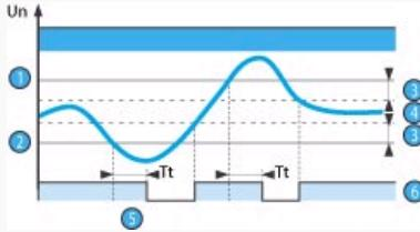
Les MUSF fonctionnent en mode fenêtre : ils vérifient que la tension contrôlée reste entre un seuil mini et un seuil maxi.
