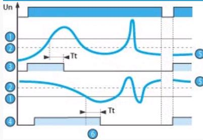
Si le mode "avec mémoire" est sélectionné, le relais s'ouvre et reste dans cette position lorsque le franchissement du seuil est détecté. Il faut couper l'alimentation pour réarmer le produit.
